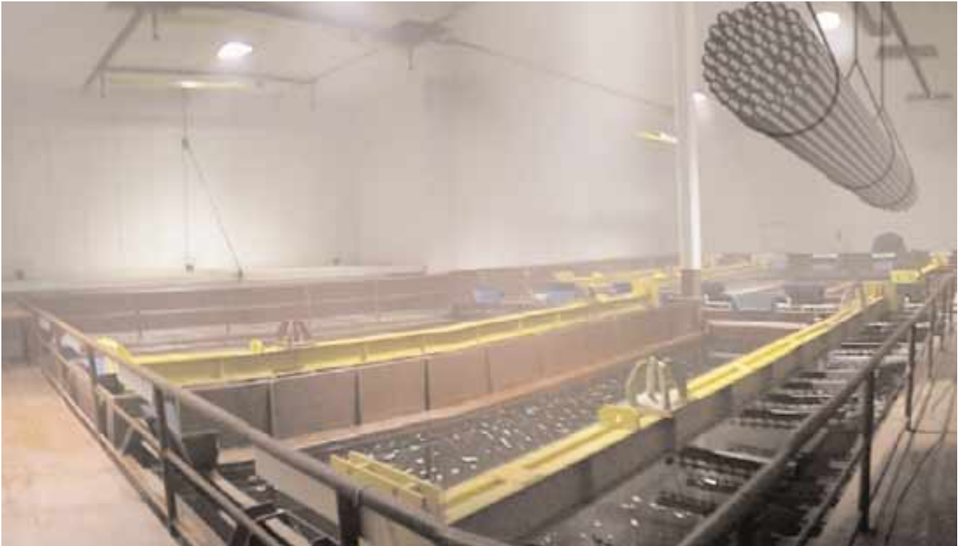
Innerhalb der gekapselten Beizerei laufen die Arbeitsschritte automatisch ab, wodurch kein Personal in diesem Bereich arbeiten muss.
