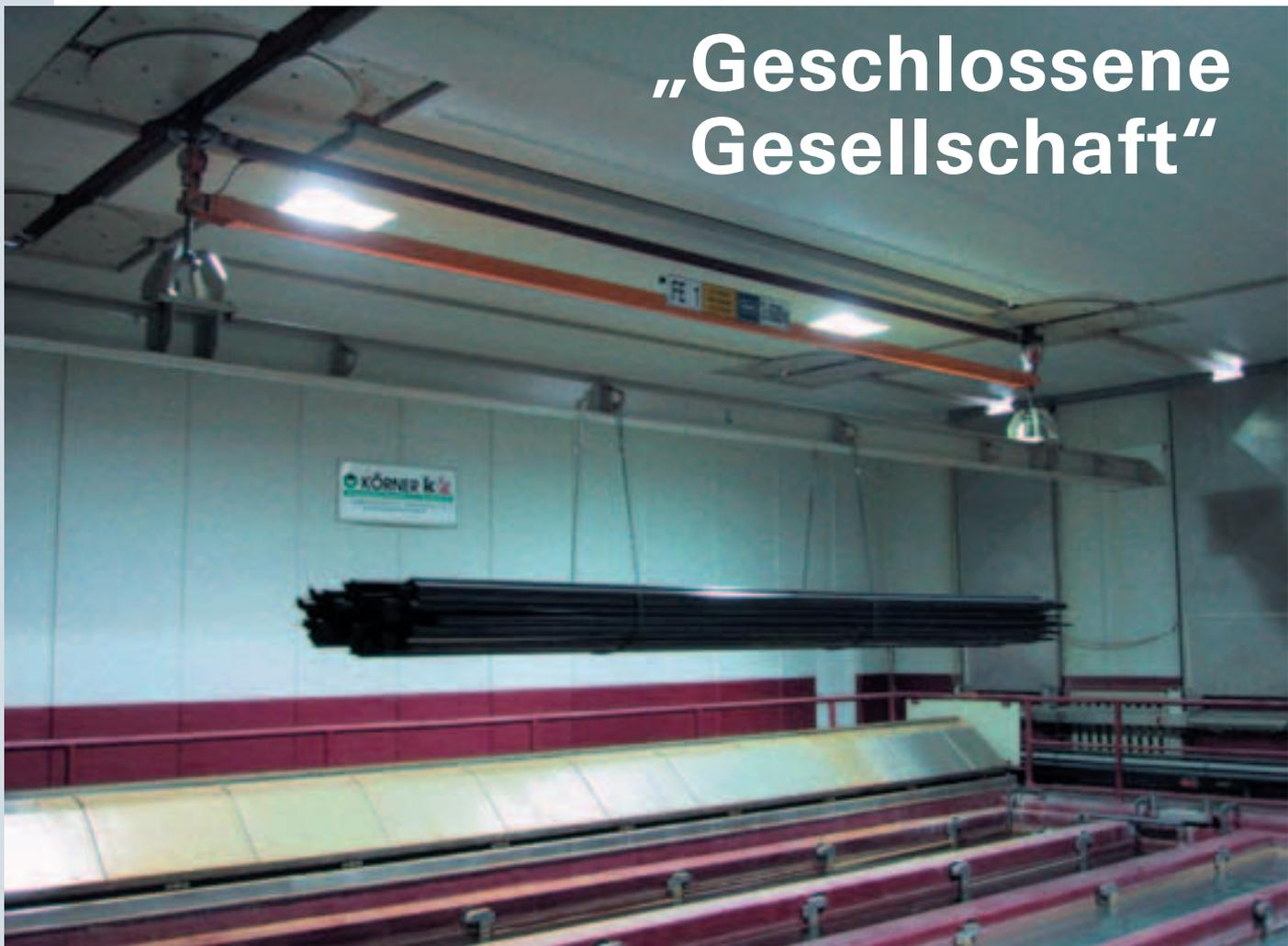
KVK-System: Die Kraneinheiten laufen oberhalb der eingehausten Vorbehandlungsanlage, lediglich Seile beziehungsweise Ketten werden durch spezielle Dichtungsschlitze in die Einhausung geführt.
