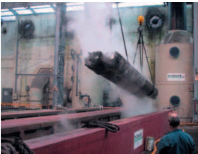
Emissionen werden durch Randaabsaugungssysteme, nicht erfaßt, wenn der Rohrbund aus dem Bad gehoben wird.
