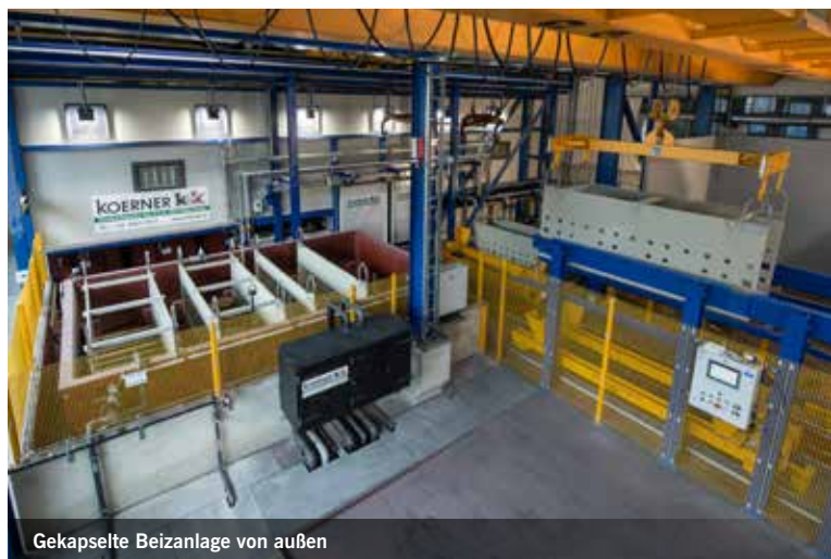
Beizbehälter für HF + HNO 3 Behälterabmessungen: 13,9 x 1,5 x 3,3 m
